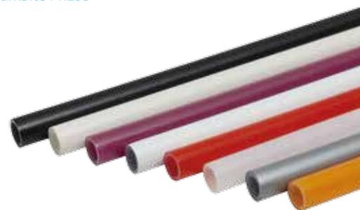
Трубы SharkBite PEXa производятся из Сшитого Полиэтилена по Пероксидной системе. В процессе производства меняется молекулярная структура полиэтилена. Этот процесс обеспечивает более высокий уровень механического и теплового сопротивления. Трубы SharkBite PEXa могут поставляться в гофрированной защитной трубе «Pipe in pipe» черного, красного или синего цвета и обычно используются в бытовых системах водоснабжения, которые нужно защитить или для обеспечения возможности удаления или замены трубы.
