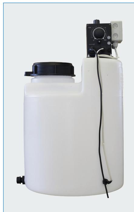
Блок мониторинга и дозирования реагентов производства АО «НПК МЕДИАНА-ФИЛЬТР» предназначен для дозирования ингибиторов коррозии и биоцида в водооборотный цикл, контроля скорости коррозии и контроля за параметрами воды в контуре (рН и/или электропроводность).
