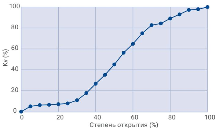
Модифицированная равнопроцентная характеристика расхода особенно эффективна для быстрого срабатывания при пиковых нагрузках (преимущество для таких процессов, как, например, нагрев/охлаждение при помощи теплообменников) и для точной настройки при низких расходах.
