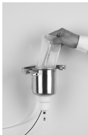
Figure 8 : Retrait de la bouteille d'électrolyte
