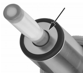
Figure 5 : Interstice avec joint torique
