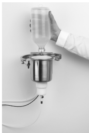
Figure 7 : Mise en place de la bouteille d'électrolyte
