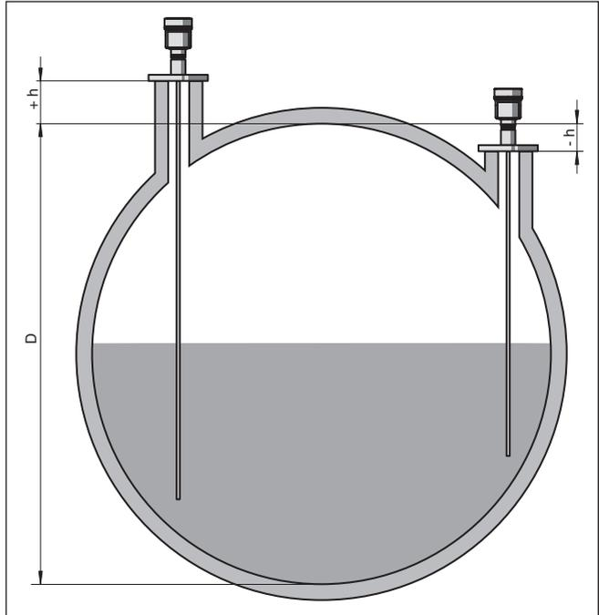
Fig. 11: Vessel height und socket correction value
