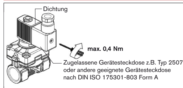
Bild 2: Elektrischer Anschluss der Gerätesteckdose
